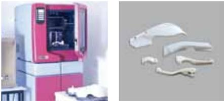
Eine weitere neue, topmoderne Maschine ermöglicht nun die Fertigung von ABS-Prototypenteilen innerhalb weniger Stunden bis zu einem Volumen von 200mm<sup>3</sup>. Bei Bedarf können mit geringen Umrüstungen auch größere Prototypen angefertigt werden.
